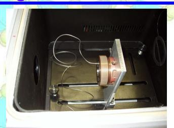
Mesures en transmission, spectromètre FT-
